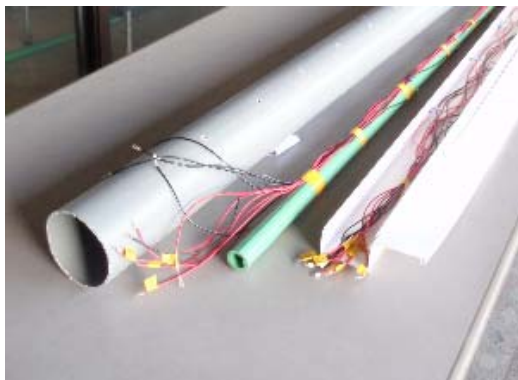
水位計頭部配線状況
