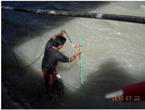
水位センサー部を水につけて作動をチェック
