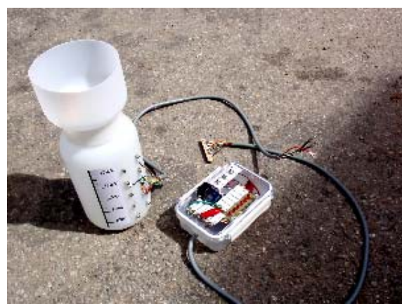
完成した雨量監視警報装置
