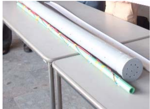
筒型水位計内挿センサー部（手前）とケーシング
