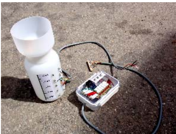
設置する雨量計セット
