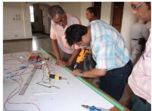
筒型センサー部支柱のせん孔
