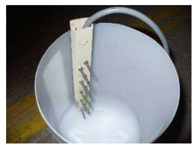
センサー取付状況
