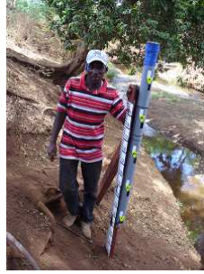
完成した水位計
