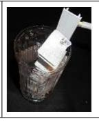
り大きくなり、実用的ではないことが予想された。 そこで、間隔 8mm で、センサーの形状もそのまま (2.5cmx3cm) の場合、どの程度の水でブザーが起動するのか試験した。 その結果、数秒のタイムラグがあるものの、工業用精製水 7割、雨水 3割でブザーの起動が確認され、試験に使った雨水よりも三倍清澄な雨水でも、このセンサーで対応できることがわかった。 また、センサーの付根と隙間にスポイトで水を滴下し、通電状況を調べた結果、水道水では僅かな水溜りでもブザーが起動するが、雨水では、雨滴がかなり厚くならないとブザーが起動しないことが分かった。 このことから、実際の雨ではこのセンサーで対応できるのではないかと予想された。
