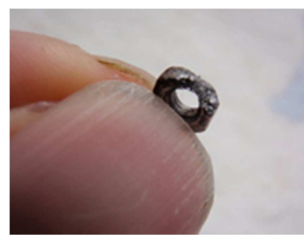
写真-6 電蝕したナット
