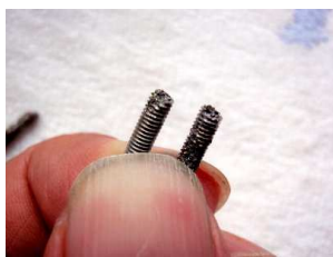
写真-7 折損したボルト
