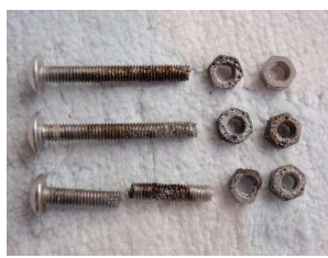
写真-5 電蝕したセンサーボルト
