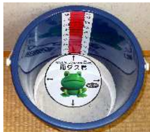
底のコンクリートとフロート
