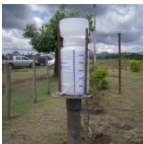
左：フィジーのVCEW雨量計 中：VCEWの改良型（インドネシアでJICA 専門家と政府職員の共同作業） 右：VCEWの改良型（ICIMODが改良しインド・アッサムに設置）
