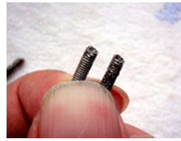
折損したボルト
