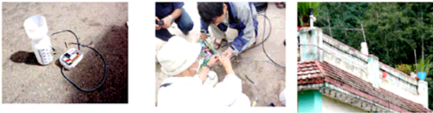
設置する雨量計セット
