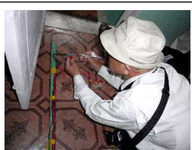
水位計センサー短絡テスト
