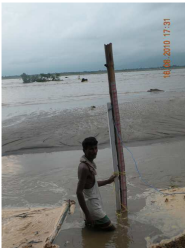
水位計設置状況
