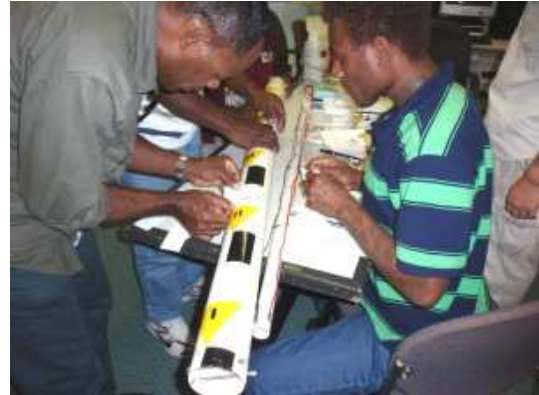
水位計ケーシングシール貼り
