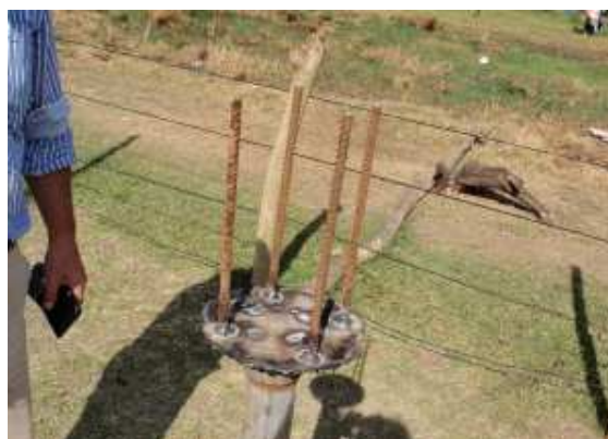
鉄製の雨量計設置台
