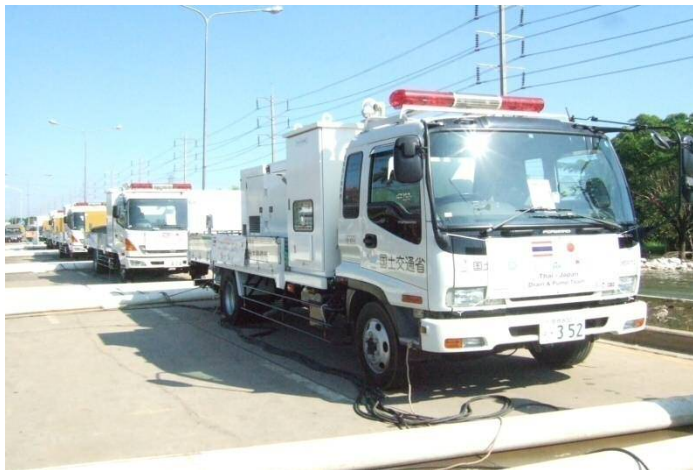
国土交通省から提供・活用された排水ポンプ車
